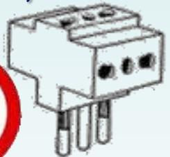
Il pericolo deriva dalla possibilità di superare la corrente massima sopportabile dalla presa e dalla possibilità di cedimento meccanico della presa e degli adattatori a causa del peso eccessivo sugli alveoli.
