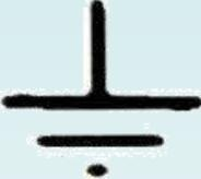
Gli impianti di messa a terra hanno un terzo filo, di colore giallo e verde, che scarica nel terreno la corrente in caso di guasto.
