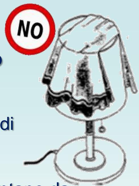
Non coprire con indumenti, stracci o altro le apparecchiature elettriche che necessitano di ventilazione per smaltire il calore prodotto.
